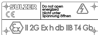
Figure 4 Placa de características ATEX
