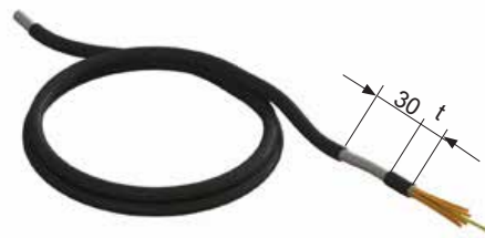
Fig. 25 Cable CEM sin 30 mm de aislamiento antes de su conexión al tablero de bornes. La dimensión «t» corresponde aproximadamente a la distancia desde la abrazadera de fijación hasta el sujetacables.
