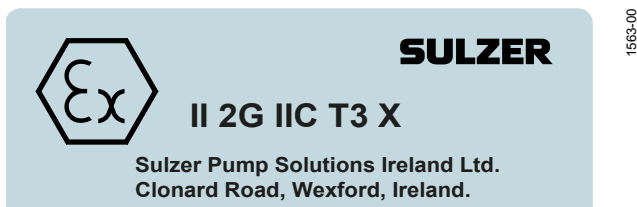
Figure 6. Autocollant indicatif sur les risques d'explosion
