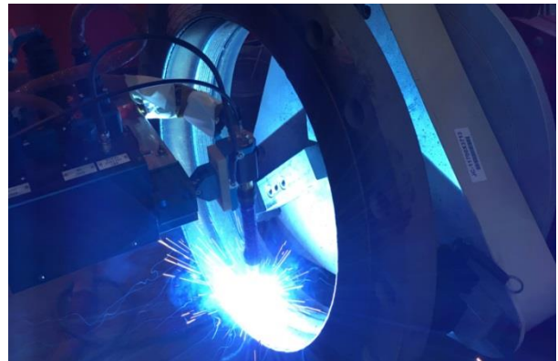
Figura 2: Construcción nueva de boquilla con Weld Overlay automático
